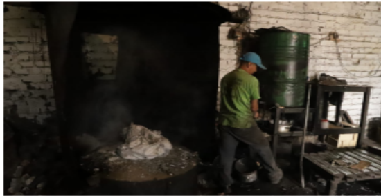
Fotografía 3. Horno tipo crisol 200 Kg con aceite usado
